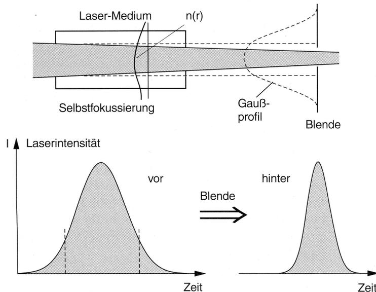
Abbildung 1: Erzeugung kurzer Pulse durch Kerr-Linse
