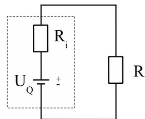
Berechnen Sie den maximalen Strom  $I_{kurz}$ , den eine Autobatterie zu liefern imstande ist (sog. Kurzschlussstrom = Strom ohne äußeren Lastwiderstand, d.h.  $R = 0$ ). Es seien  $U_Q = 12 \text{ V}$  und  $R_i = 0.04 \text{ \Omega}$  gegeben. Berechnen Sie darüberhinaus die Batteriespannung als Funktion eines Lastwiderstandes  $R$ .
