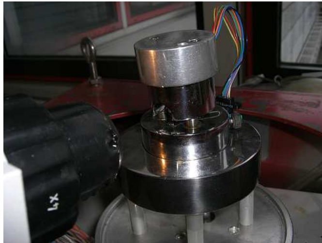
Abbildung 9: Schematische Abbildung des piezoelektrischen Hohlzylinders [7]
