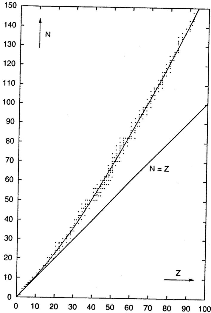
Abb. 2.26. Neutronenzahl stabiler Kerne als Funktion der Protonenzahl  $Z$
