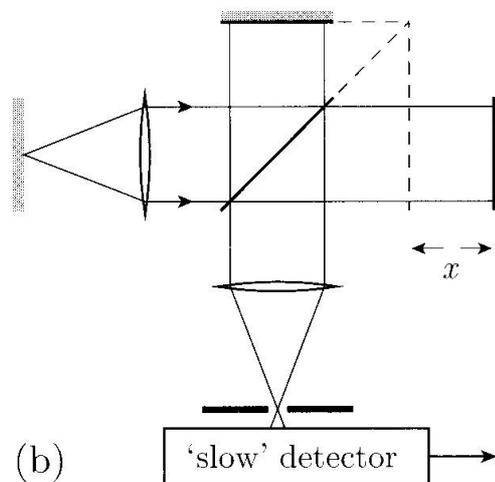
Abbildung 2: Prinzip eines Michelson-Interferometers
